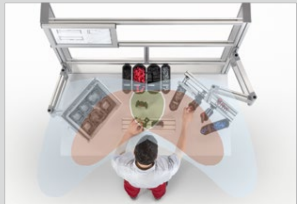
Greifraum Arbeitsplatz Berücksichtigung der Zonen, Beihandzone (Direkt vor dem Mitarbeiter, dort findet der Prozess statt), Einarmzone (optimaler Zugriff auf Werkzeuge etc., ohne den Körper zu drehen)
