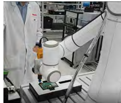
Platinenverschraubung im BOSCH-Werk
