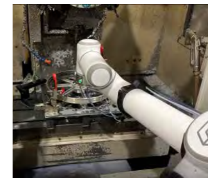
Be- und Entladen von Getrieben mit Maschinenbeschickung
