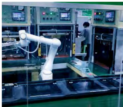
Bedienung von 3 Arbeitsbereichen mit Cobots gleichzeitig
