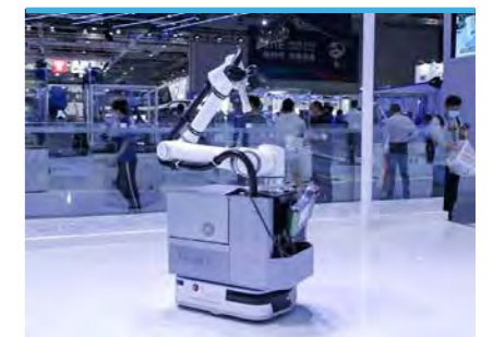
AMR-Demonstration mit Geek+ AGV für die Betankung von E-Fahrzeugen
