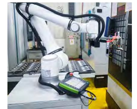
Be- und Entladen von Roh und Fertigteilen
