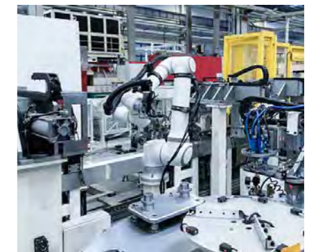
Be- und Entladen von Triebwerken in einem Raumfahrtunternehmen
