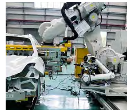
Verschraubung von Karosserieteilen
