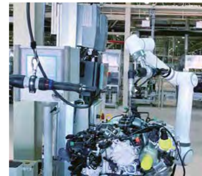
Anziehen von Motorbolzen
