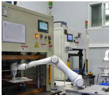
Be- und Entladen von digitalen Bauteilen
