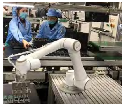
Verschraubung des Außenblechs der Kühlaggregate
