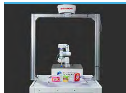
Sortierlösung mit der 3D-Kamera von Solomon
