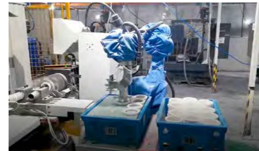
Pick-and-Place von Salzkernen mit Vision-System
