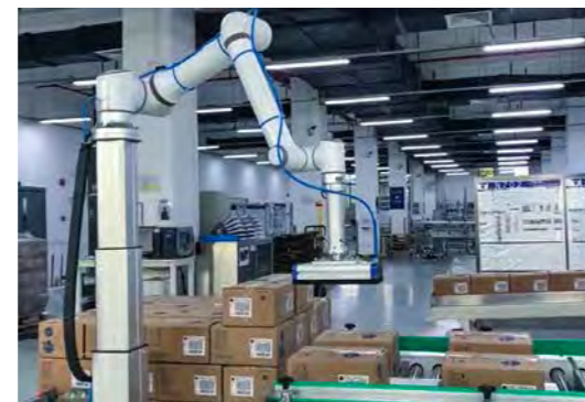
Hubsäulenpalettierung mit verschiedenen Greifern
