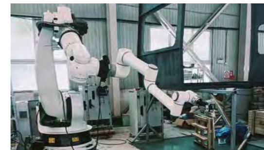
Fusionieren mit Industrieroboter für die Lackierung von Buskarosserien
