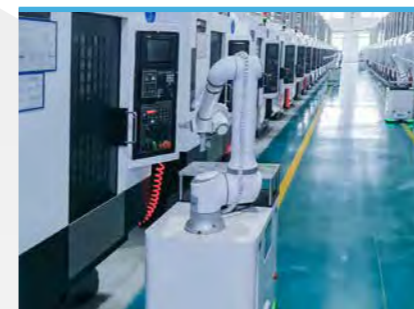
Maschinen-beschickung mit Standard FTF-Robotern
