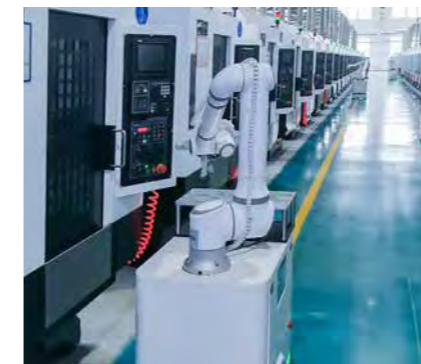
CNC-Maschinenbeschickung mit AGV
