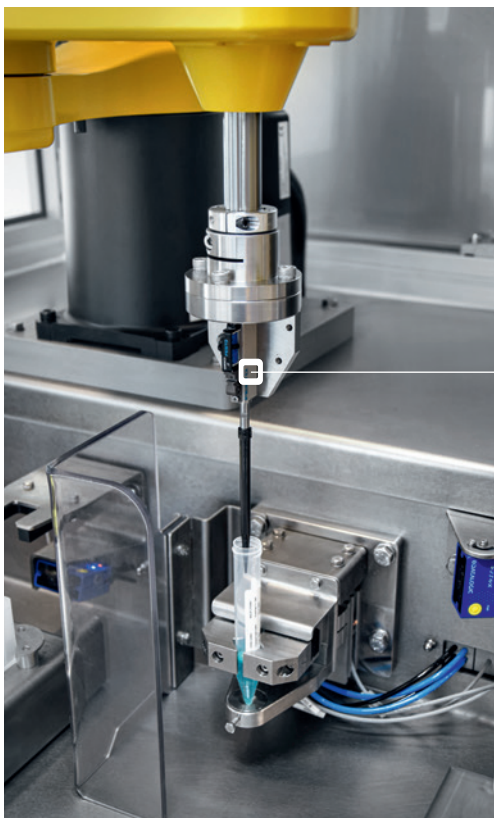
Kleinste Pipettier volumina: Der zweite Roboterarm mit dem Pipettierkopf verteilt Flüssigkeiten auf eine Mikrotiterplatte.
