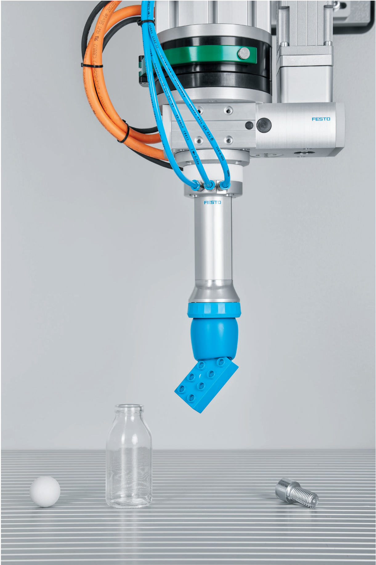
Lernen von der Natur: Der Adaptive Formgreifer ist von der Zunge des Chamäleons inspiriert. Mit ihm lassen sich Gegenstände mit unterschiedlichsten Konturen und Formen greifen.
