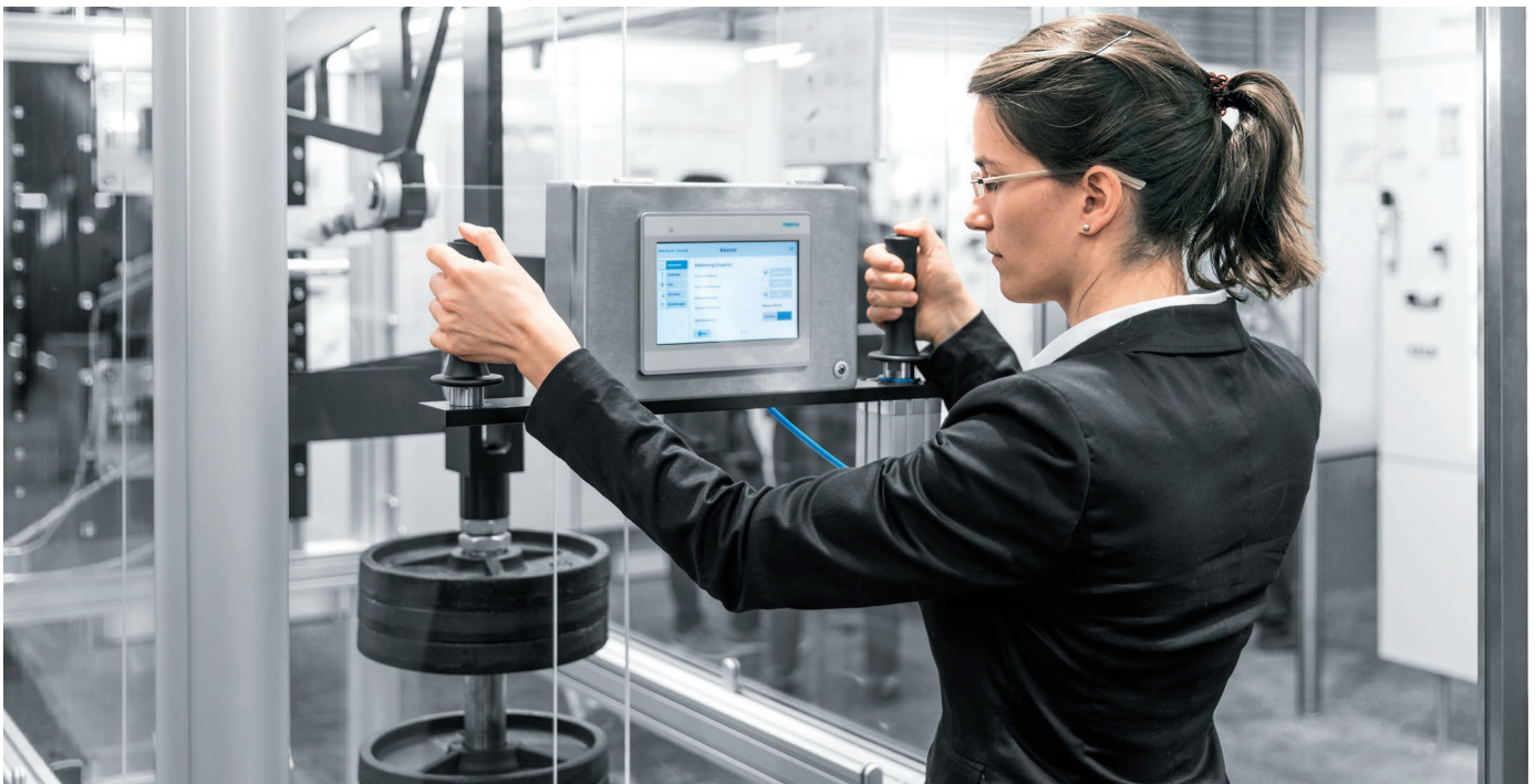
Spielend leicht schwere Massen bewegen: mit dem innovativen Handgriff, der das Stellsignal zur Bewegung des Balancer-Systems erzeugt.
